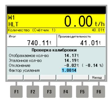
**Отображаемый** Индикация полученного веса на IT *BELT E*. Значение можно удалить клавишей
